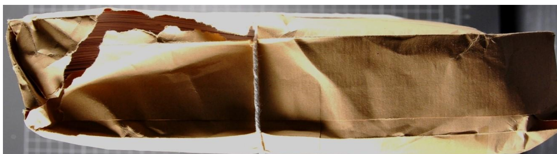
Fig. 4 - Colet deteriorat ca urmare a legării necorespunzătoare în sistem plasă
