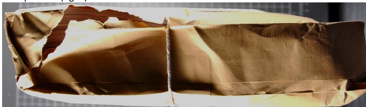
Fig. 4 - Colet deteriorat ca urmare a legării necorespunzătoare în sistem plasă
