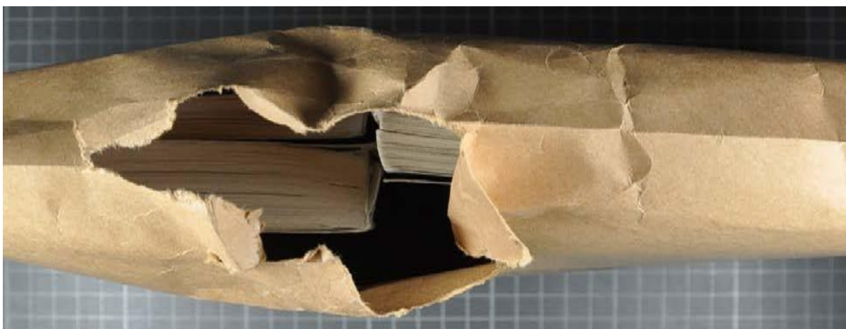
Fig. 7 - Deteriorarea ambalajului din cauza împachetării necorespunzătoare a broșurilor
